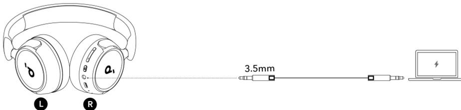
Reproduzca audio en un dispositivo externo conectando el cable AUX de 3,5 mm suministrado. La escucha con cable se desconectará automáticamente del modo Bluetooth.
