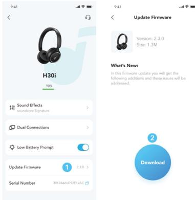
Se le avisará cuando se detecte una nueva versión de firmware al conectar los auriculares con la aplicación. Compruebe que los auriculares estén encendidos y conectados a un dispositivo hasta que termine la actualización del firmware. Durante la actualización, evite cualquier uso y asegure un acceso estable a internet.
